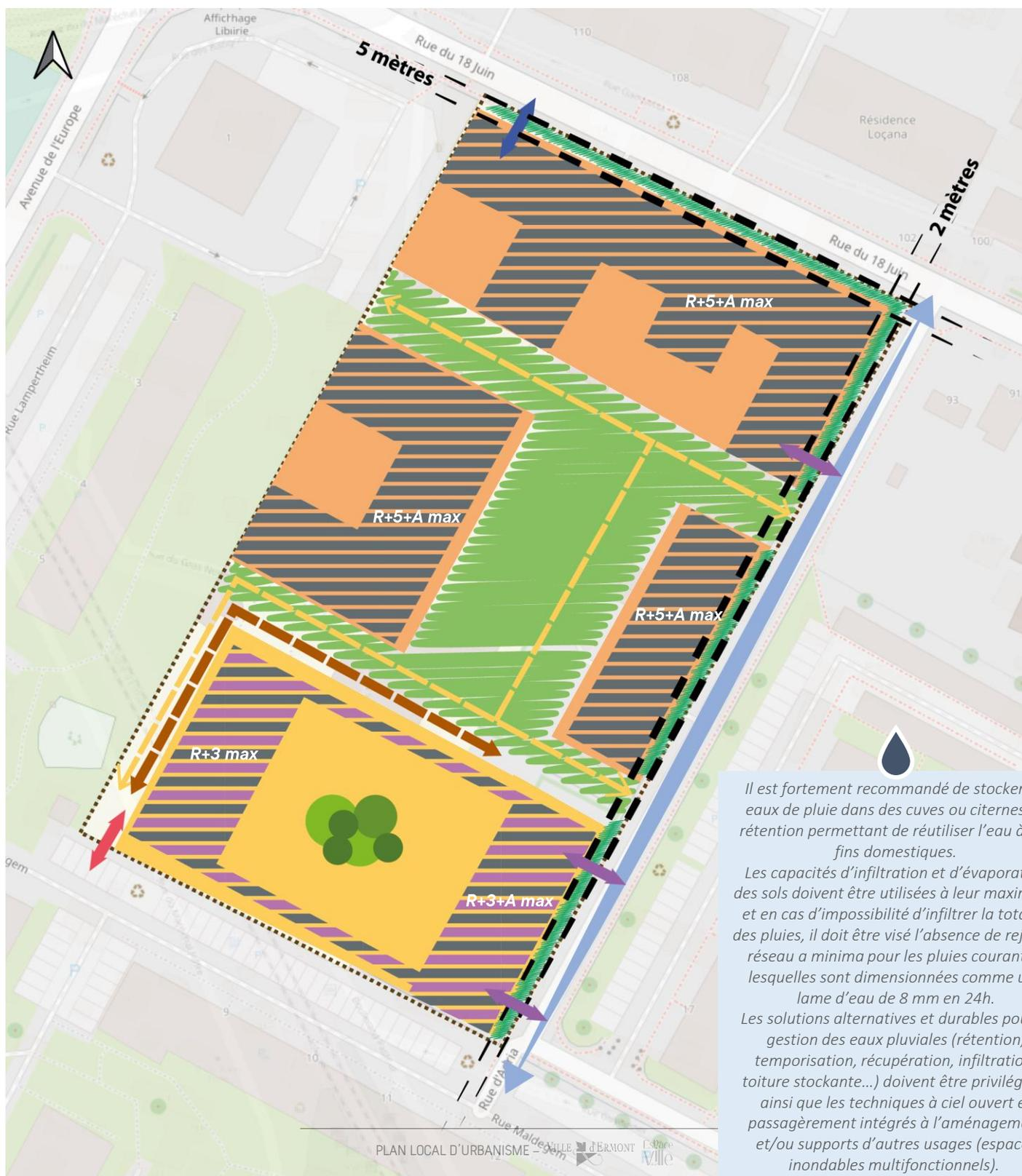
Il est fortement recommandé de stocker les eaux de pluie dans des cuves ou citernes de rétention permettant de réutiliser l'eau à des fins domestiques.
